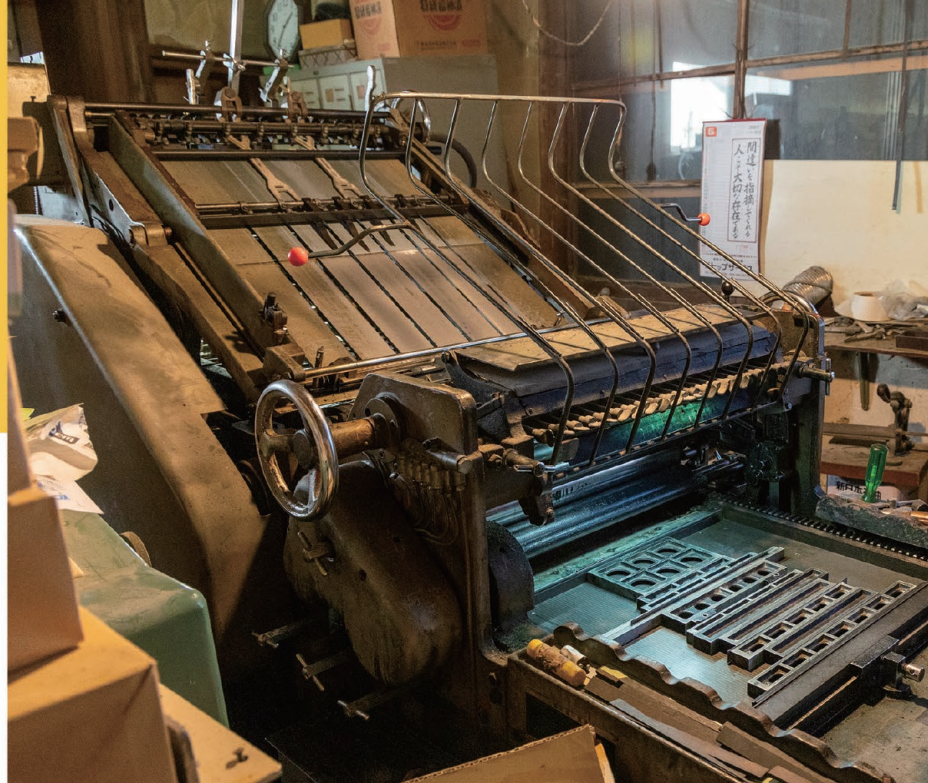
今も現役で動き続けている活版印刷機。ミシン目加工やナンバリングに活躍しています
